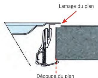
Le rebord de l'évier vient reposer dans le lamage effectué sur le plan de travail, au même niveau que ce dernier (pas de saillie).
