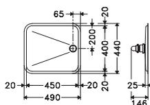
Bonde  $\varnothing$  70 à écoulement libre
