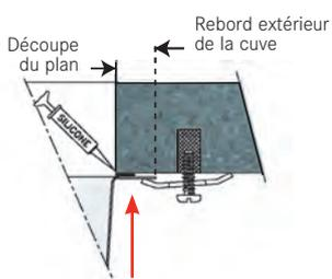
La cuve (ou l'évier) vient se fixer sous le plan de travail (rebord invisible). Il convient d'effectuer scrupuleusement la découpe du plan à l'aide du gabarit ou d'un plan coté.
